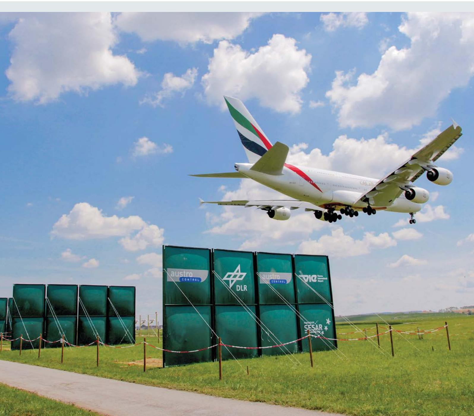
Mit der „Plate Line“ kann das Zerfallen von Wirbelschleppen beschleunigt werden. Foto: DLR
